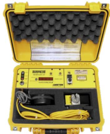
O teste de arraste consiste na medição do tempo de parada da prensa com base no acionamento dos dispositivos de segurança. As medições são realizadas por um profissional altamente qualificado, com equipamento específico calibrado periodicamente. A Amiltech realiza de 10 a 30 ensaios consecutivos em cada prensa, de forma a obter o maior tempo de parada da máquina. Na conclusão do processo serão entregues ao cliente os seguintes itens:
